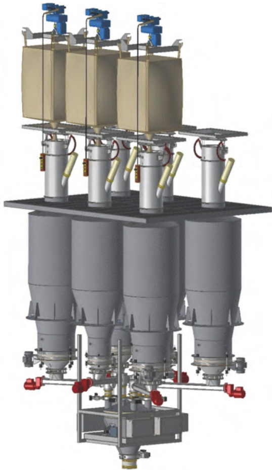
Bild 7: Silobefüllung aus FIBCs, Entleerung der FIBCs mittels Schwerkraft (AZO GmbH + Co. KG)
