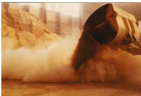
Bild 19: Staubwolkenbildung bei offenem Schüttgutumschlag (Prof. Siegfried Radandt)
