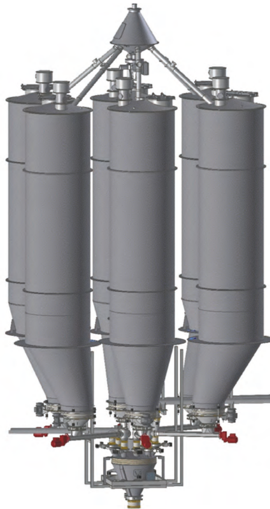
Bild 8: Silobefüllung über Drehrohrverteiler (AZO GmbH + Co. KG)
