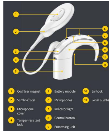
Abbildung 10: Beispiel der technischen Umsetzung der von außen zugänglichen Systemkomponenten (Quelle [2]).
