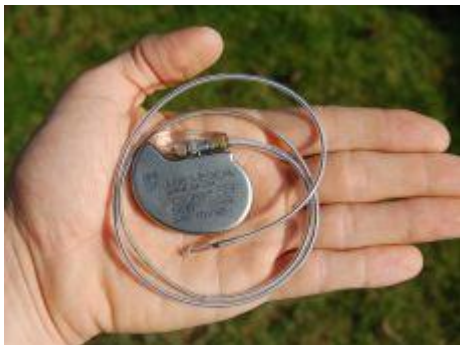
Abbildung 14: Komponenten eines Herzschrittmachers (Quelle [6]).
