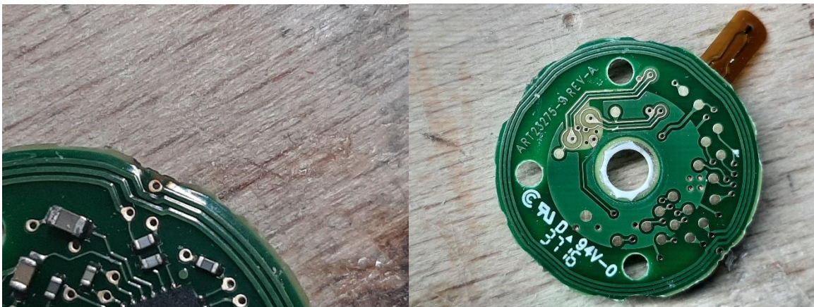
Durchkontaktierung der Spule
