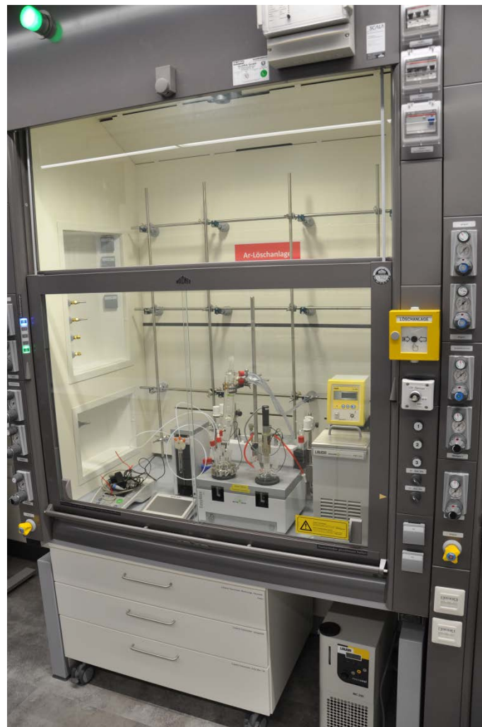
Abb. 1: Höhenverstellbarer unterfahrbarer Laborabzug. Die Schränke stehen auf Rollen und können nach Bedarf herausgefahren werden, um Platz für eine (im Rollstuhl) sitzende Person zu machen. Wichtige Bedienelemente können auch im Sitzen erreicht werden. Neben der akustischen Alarmierung der Abzugsfunktion ist auch eine doppelte optische Anzeige (in Augenhöhe und oberhalb des Frontschiebers) angebracht. Eine dort arbeitende Person erhält zudem eine jederzeit erreichbare, mobile Einzelarbeitsplatzsicherung mit Alarmtaster.
