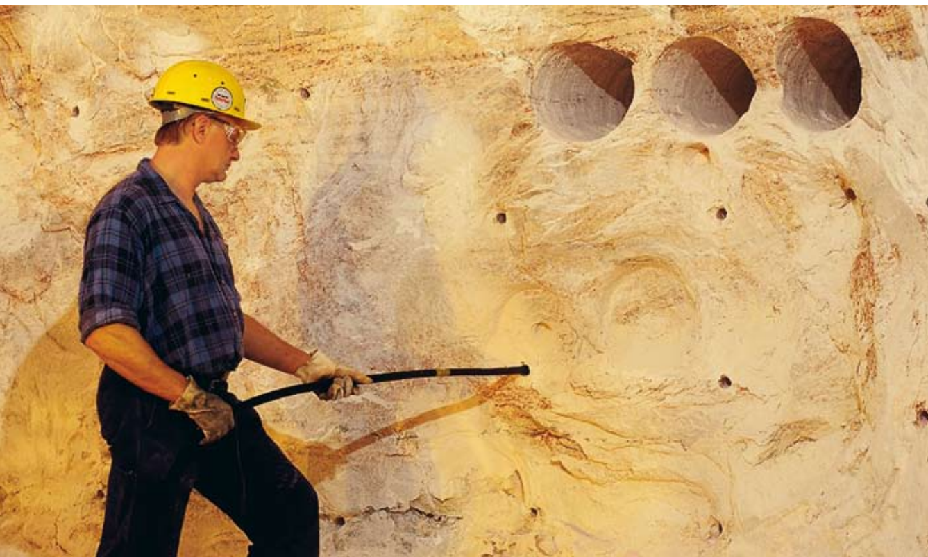
Sprengvorbereitung im Grubenbetrieb des Kaliwerkes Neuhoof-Ellers: In die vorgefertigten Sprenglöcher wird geprüllter Sprengstoff eingeblasen.
