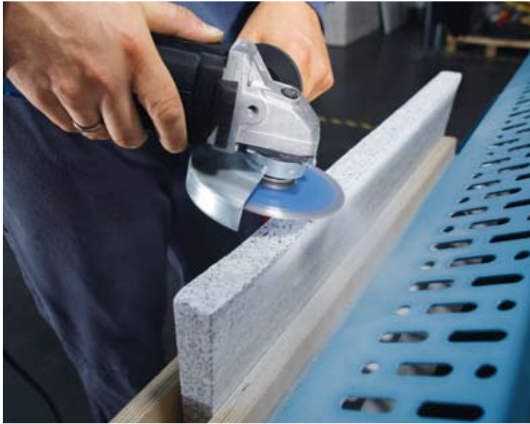
Beim Bearbeiten von Granitplatten kann der entstehende gesundheitsschädliche Staub an Absaugtischen aus der Atemluft gefiltert werden.
